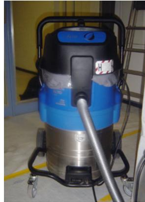
3 Industriestaubsauger mit Filter für Staubklasse H (Asbest)
