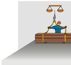
2 Wird das Transportgut in ausbalancierter Lage angeschlagen?
