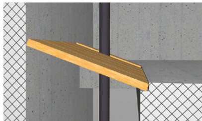
2 Kleine Bodenöffnung im Wandbereich mit verkeiltten Brettern
