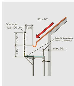
3 Dachdeckerschutzwand bei Dachneigungen von 30° bis 60°
