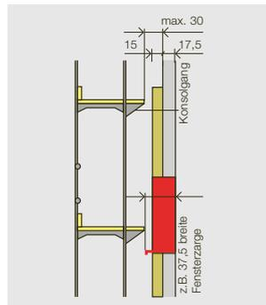
2 Lösungen bei Fassadenabstand über 30 cm
