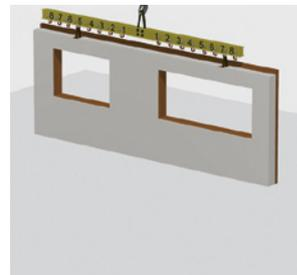
3 Mit Hilfe einer Traverse hängt die Last im Gleichgewicht.
