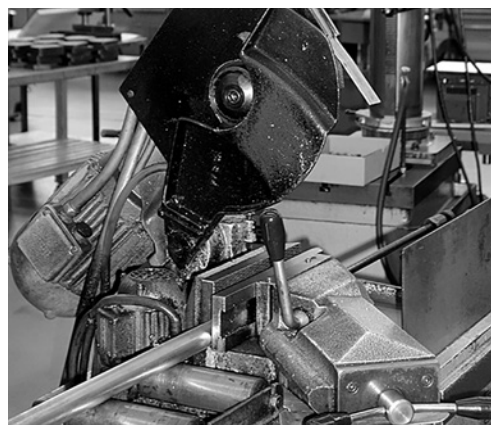
4 Sega circolare a mano schermata in posizione di riposo
