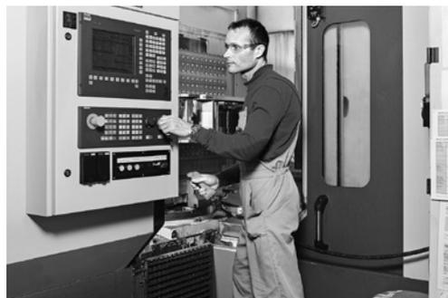
5 Con questa macchina conforme alle norme è possibile lavorare da soli esclusivamente in esercizio normale. In caso di eliminazione di guasti, sostituzione di un utensile e manutenzione bisogna garantire il contatto visivo e a voce con una seconda persona.
