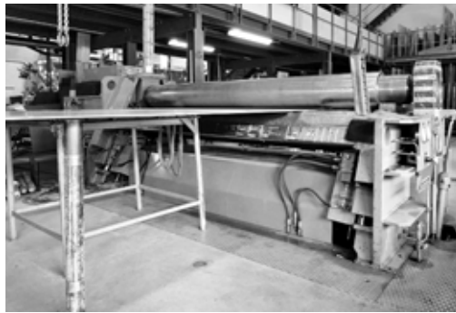
Bild 5: Seitenhalter (Auflagetisch) zum Führen grosser, instabiler Bleche.
