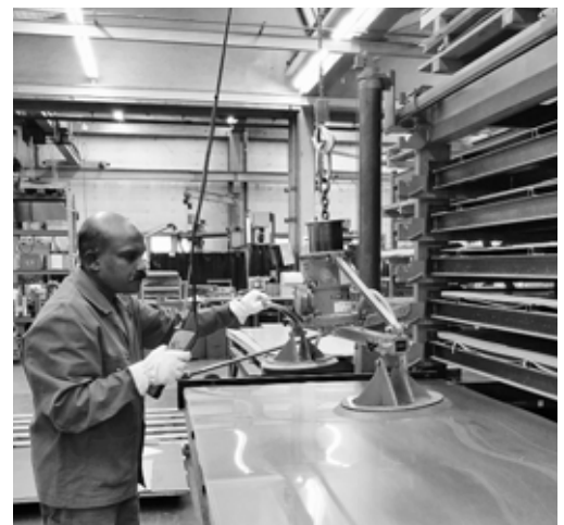
Bild 2: Vakuumsauger für das Heben eines Bleches.
