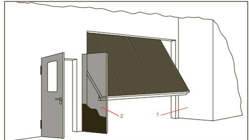
4 Bauliche Massnahmen zur Sicherung der zugänglichen Klemmstellen an den Nebenkanten eines Kipptores.
