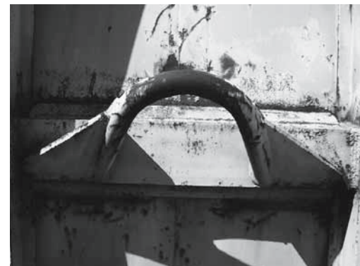
Fig. 5: è necessario controllare le eventuali incrinature e deformazioni dell'anello di sollevamento e dei dispositivi di sospensione del carico.
