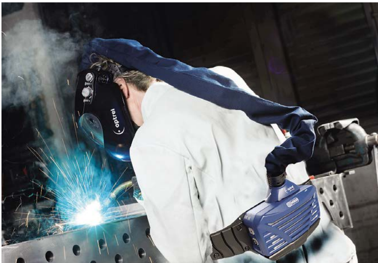
Bild 3 Atemschutz beim MSG-Schweißen: Gebläsefiltergerät mit Schweisserhelm und wiederverwendbarem Partikelfilter der Klasse TH3P R SL
