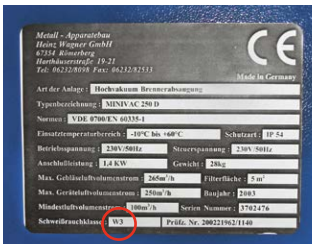
Bild 2 Typenschild einer Brennerabsaugung mit der Schweißrauchabscheideklasse W3
