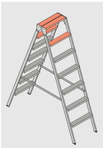
**28** Ne pas utiliser les deux dernières marches d'une échelle double à deux plans de montée.
