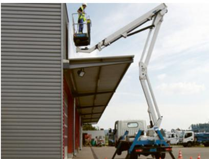
7 Plateforme élévatrice mobile de personnel multidirectionnelle non automotrice
