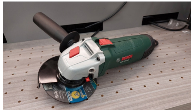
Figura 1 Troncatrice a mola con dispositivo di sicurezza (fonte: Electrosuisse)
