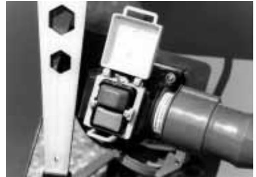
Un interrupteur encastré ou positionné en contrebas permet de prévenir une mise en service involontaire de la scie circulaire.
