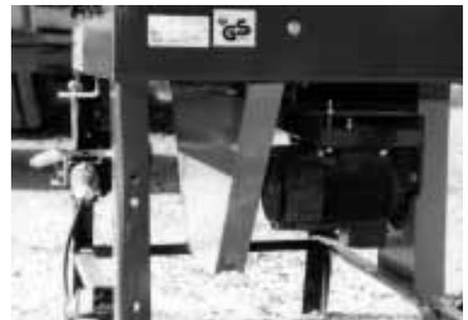
La lame de scie doit être encaissée de telle sorte que ses dents soient hors d'atteinte (encaissement inférieur: min. 15 cm, largeur: max. 10 cm).
