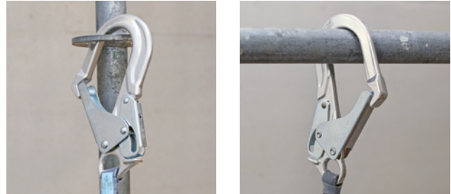
5 und 6 «Rohrhaken» dürfen nur senkrecht und ohne Querbelastung eingesetzt werden.
