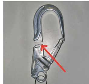
7 Quer belastete «Rohrhaken» können zu Bruch mit Absturz führen
