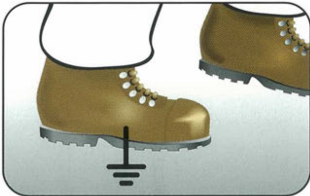
Figura 37: Esempi pratici di misure di sicurezza durante l'utilizzo di liquidi infiammabili: usare solo recipienti conduttori, mettere a terra durante le operazioni di travaso. Tutti gli elementi d'impianto conduttori (p. es. anche la pompa) vanno messi a terra durante il travaso, le persone vanno messe a terra tramite scarpe e pavimenti conduttori.
