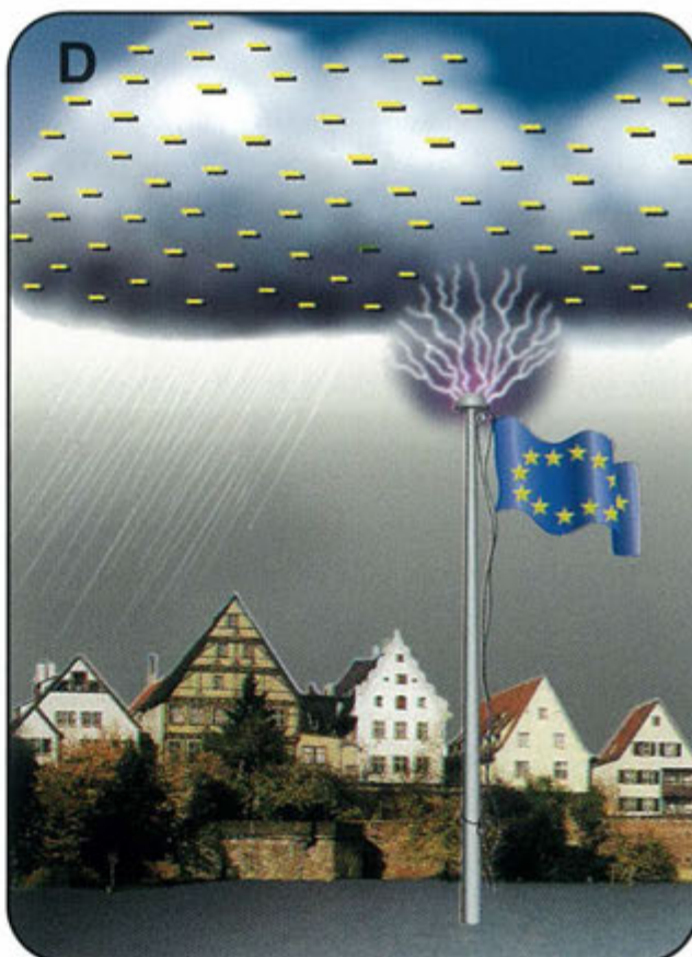
Figura 23: Esempi pratici di scariche ad effluvio dovute a – A: un contenitore per materiale in polvere caricato elettrostaticamente B: un liquido isolante caricato C: una nube di polvere caricata D: una nube temporalesca caricata.
