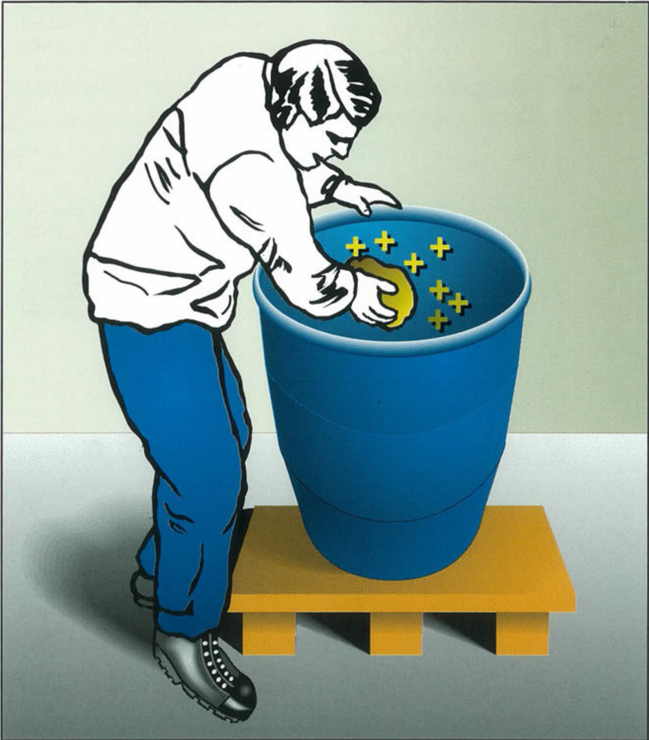
Figura 35: Accumulo elevato di cariche dovuto a strofinio (processi secondari)
