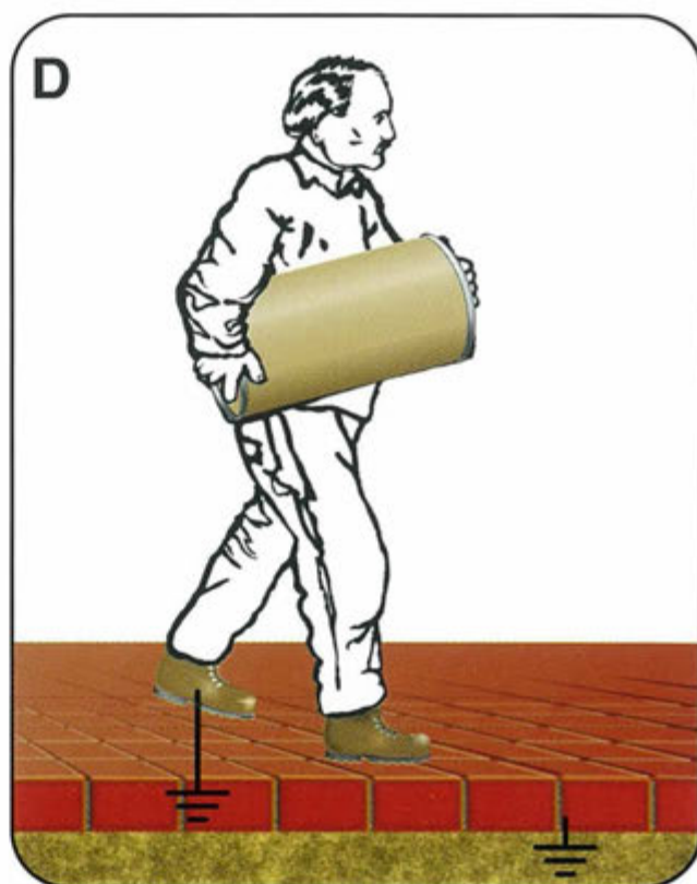
Figura 39: Esempi pratici di misure di sicurezza durante la manipolazione di polveri infiammabili – A: messa a terra di tutti i recipienti e imballaggi conduttori durante il travaso B: messa a terra di tutti gli elementi conduttori dell'impianto C: misure di tipo costruttivo (p. es. soffocamento dell'esplosione) D: messa a terra delle persone durante la manipolazione di materiale sfuso molto sensibile all'innesco
