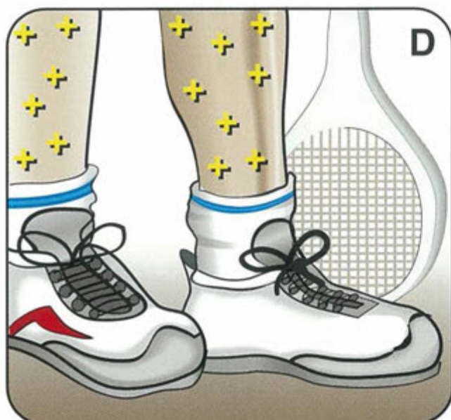
Figura 11: Esempi di accumulo di cariche su parti conduttrici isolate elettricamente da terra – A: tubo con guarnizioni isolanti B: fusto metallico su un foglio isolante C: trucioli di metallo in un fusto di plastica D: persona con scarpe isolanti E: flangia metallica su una tubazione di vetro
