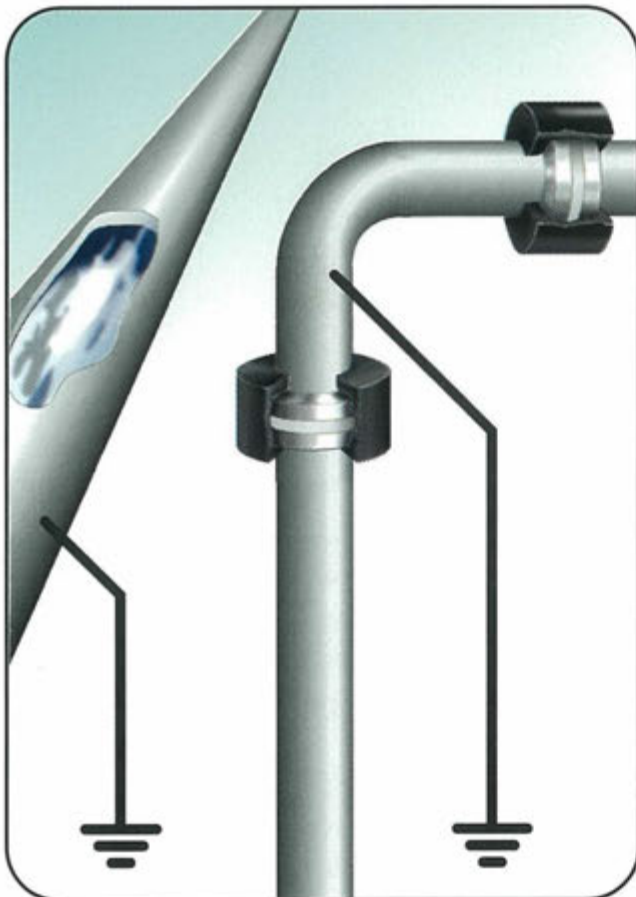
Figura 21: Esempi di come evitare scariche disruptive mettendo a terra tutti gli elementi e i prodotti conduttori (vedi figura 20)
