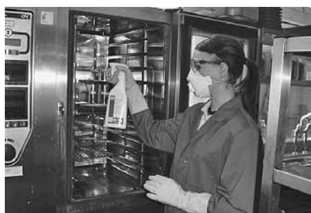
Fig. 18: quando si spruzzano detergenti concentrati la maschera di protezione FFP2 protegge le vie respiratorie.
