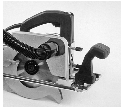
4 Handkreissäge, an den Staubsauger angeschlossen
