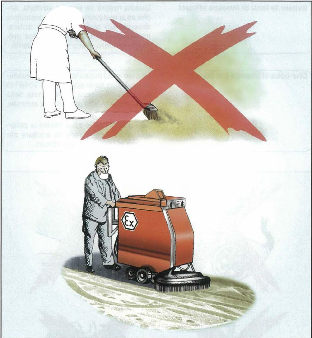
*Figura 8 - Per evitare di sollevare nuvole di polvere è consigliabile ricorrere a un aspirapolvere industriale.*
