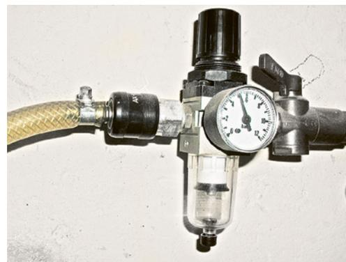
6 Régulateur de pression avec soupape de sécurité incorporée
