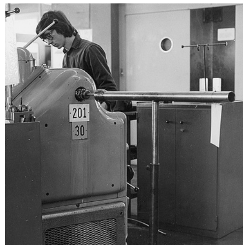
8 Die Stangenführung hält die Stange beim Drehen.
