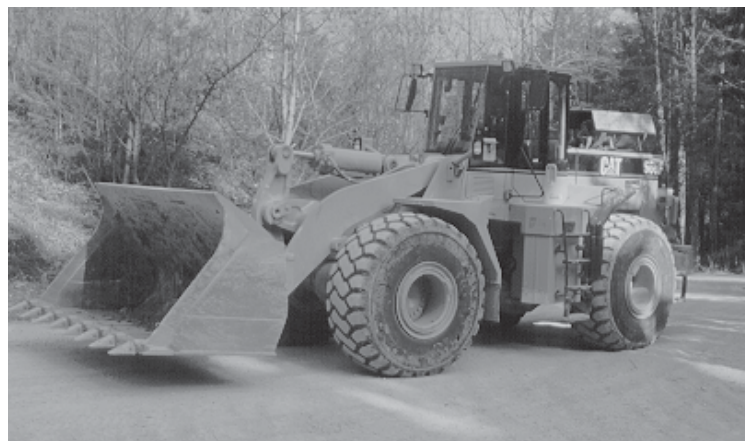
Figure 1: Utilisation dans les conditions difficiles régnant dans une carrière d'une chargeuse sur pneus Caterpillar 966 F, équipée d'un filtre à suie DSI
