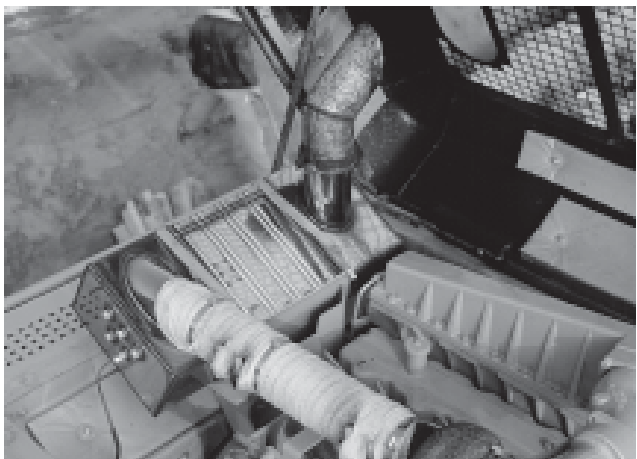
Filtre SHW monté sur un excavateur sur chenilles CAT 330, à la place du silencieux.
