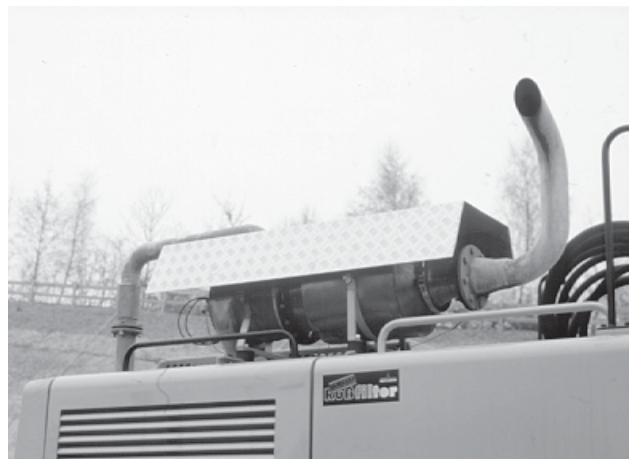
Filtre KHD/DSI monté sur un excavateur sur chenilles LIEBHERR 942. Lors des essais sur le terrain, on a toléré la limitation de la vue liée à l'installation de ce filtre. En utilisation normale, celui-ci devrait être installé sous le capot.
