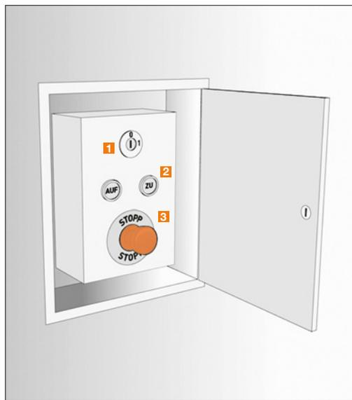
2 Système de commande d'ouverture de la trappe
