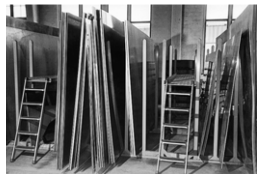
Fig. 3: magazzino verticale per lamiere.
