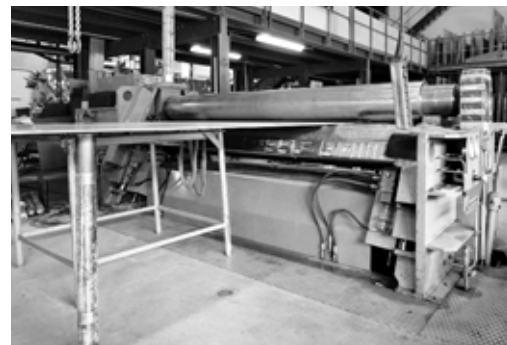
Fig. 5: supporto laterale (tavola di appoggio) per l'alimentazione di lamiere instabili di grandi dimensioni.
