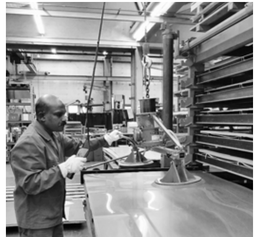
Fig. 2: ventose a vuoto per sollevamento lamiere.
