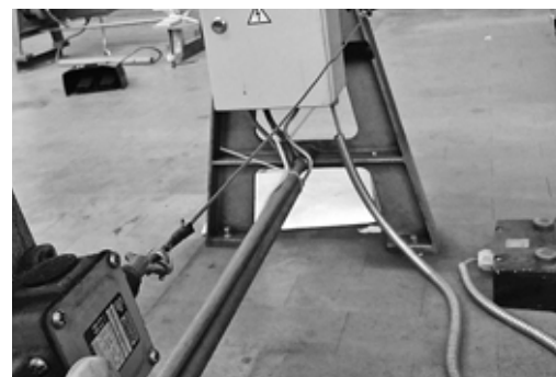
Fig. 6: funicella per arresto di emergenza sull'intera lunghezza dei rulli.
