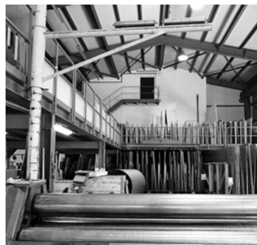
Fig. 8: supporto centrale per l'alimentazione di lamiere instabili di grandi dimensioni.
