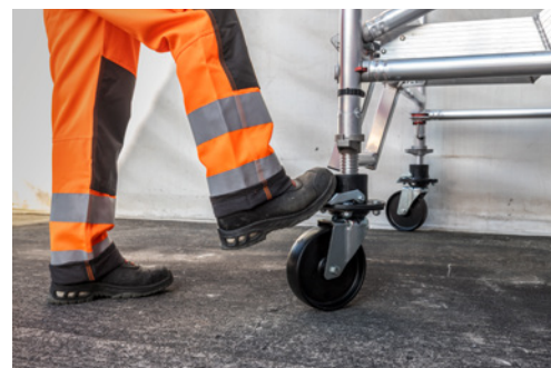
5 Um ein ungewolltes Wegrollen zu verhindern, müssen die Rollen gesichert sein.
