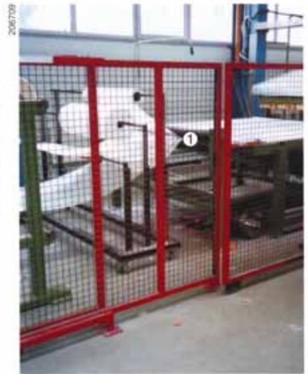
Figura 25: la zona di pericolo di tutti gli elementi di questo impianto e le zone d'imbocco dei cilindri (1) sono protette per l'esercizio normale con un recinto e con una porta d'accesso provvista di un dispositivo di blocco (ripari di segregazione asserviti).
