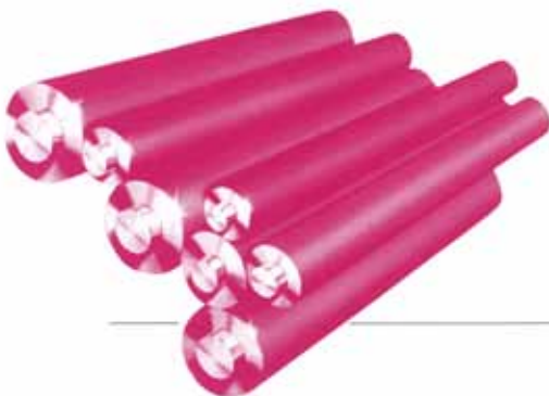
Figura 6: coppia di cilindri con linea d'imbocco non superiore a 120 mm. La velocità periferica del cilindro ( V_1 ) è maggiore di quella del cilindro ( V_2 ). Esiste il pericolo di trascinamento di dita, mani e braccia.
