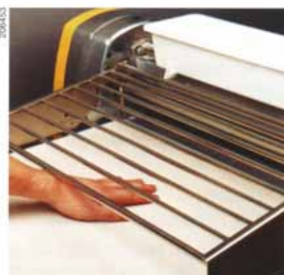
Figura 27: sfogliatrice in un'azienda alimentare. Le zone d'imbocco ai cilindri sono protette con un riparo (griglia) asservito provvisto di apertura d'alimentazione.
