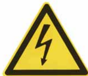
Figura 50: tensione elettrica pericolosa (codice Suva 1729/69)
