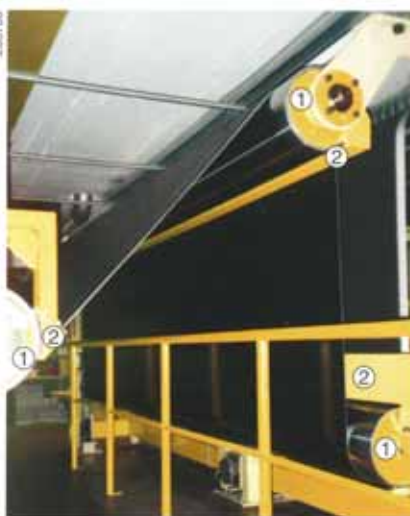
Figura 21: impianto di rivestimento in un'azienda della lavorazione di materiale sintetico. Zone d'impatto ai cilindri di rinvio (1) protette con barre sensibili (2).
