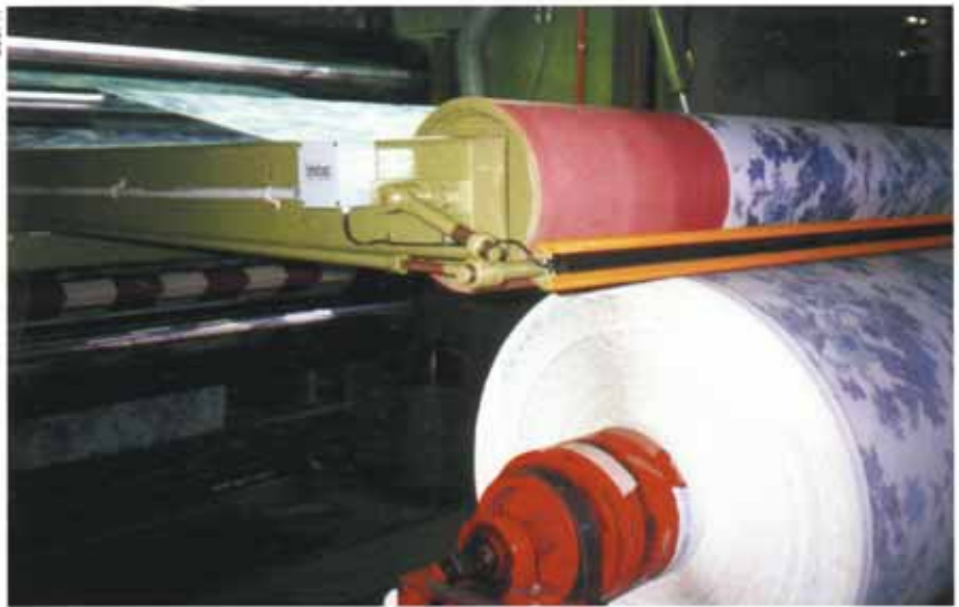
Figura 35: avvolgimatassa di una calandra in un'azienda tessile. La zona d'imbocco fra il cilindro conduttore (2) e la matassa (3) è protetta, per l'esercizio sia normale che particolare, mediante una barra sensibile comandata combinata con un listello sensibile (1). Il contatto con il listello sensibile provoca l'arresto del cilindro conduttore e un suo sollevamento dalla matassa.
