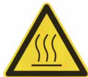
Figura 49: pericolo superficie calda (codice Suva 1729/68)
