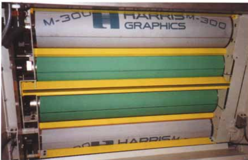
Figura 19: macchina per stampa offset a rulli in un'azienda grafica. Le zone d'imbocco dei cilindri risp. rulli sono protette con barre sensibili sia per l'esercizio normale sia per quello particolare.
