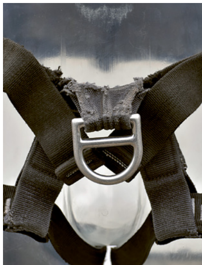
2 Ce harnais fortement endommagé doit être remplacé (de plus ce n'est pas un harnais complet selon EN 361).
