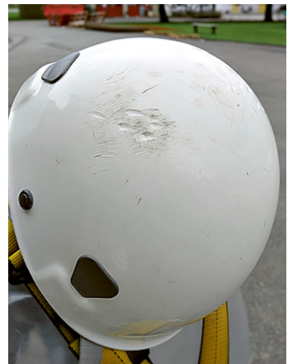
3 Ce casque visiblement endommagé doit aussi être remplacé.
