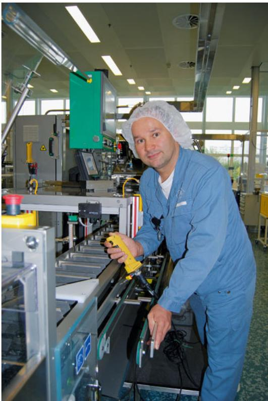
In condizioni di esercizio particolare l'operatore avvia la macchina mediante un attrezzo manuale dotato di dispositivo di consenso e tasto a impulsi.
