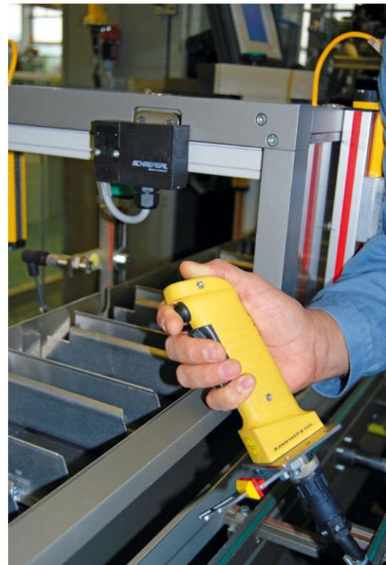
Per l'esercizio particolare l'astuciatrice è dotata di un comando manuale con dispositivo di consenso a tre livelli e tasto ad impulsi.
