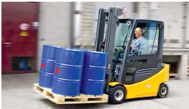
Lors du transport au sein de l'entreprise, des conteneurs peuvent être endommagés. Les liquides facilement inflammables<sup>1</sup> qu'ils contiennent le cas échéant peuvent alors s'échapper et provoquer des atteintes à la santé, des incendies et des explosions.
