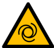
Figure 3: Signal d'avertissement «Démarrage intempestif» sur le capot de contacteurs
