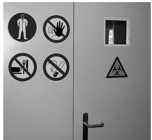
Figura 4: i pericoli presenti nei locali di lavoro, l'accesso limitato, l'obbligo di indossare gli indumenti protettivi e il divieto di mangiare, bere e fumare devono essere segnalati con gli appositi segnali di sicurezza.
