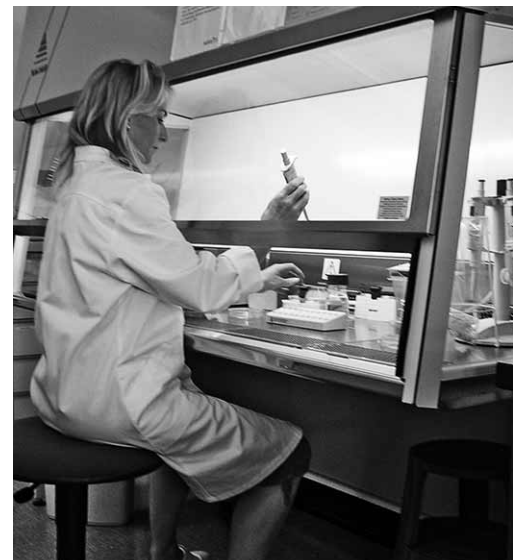
Figura 1: protezione contro gli aerosol grazie ad una cabina di sicurezza microbiologica.
