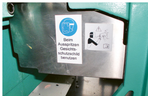
8 Lors d'interventions sur l'unité d'injection, il faut se protéger contre les projections de plastique brûlant avec un écran facial, des gants et des vêtements de travail fermés.
