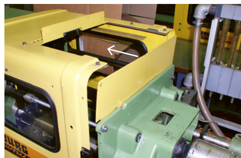
2 Ouverture d'accès avec tôle de protection repoussée sur une petite presse.
