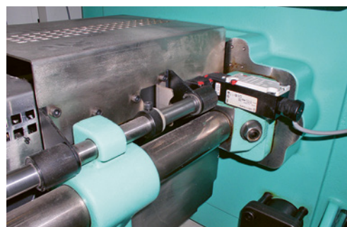
4 L'ouverture du protecteur mobile surveillé électriquement stoppe les mouvements dangereux.
