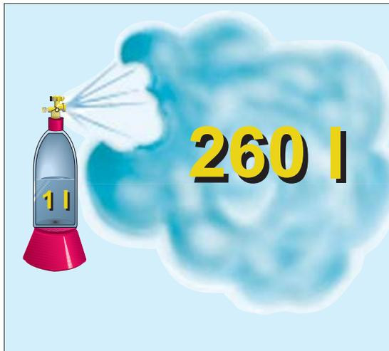
Bild 12: Volumenzunahme beim Verdampfen von Propan [4].
