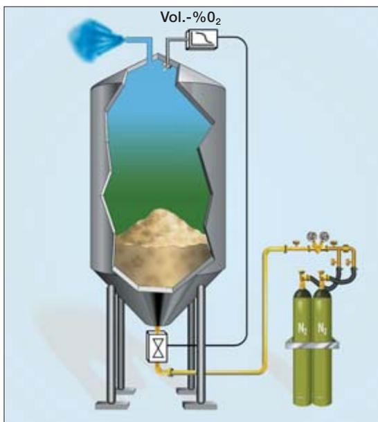
Bild 31: Inertisierung mit Stickstoff und Überwachen der Sauerstoffkonzentration [3].
