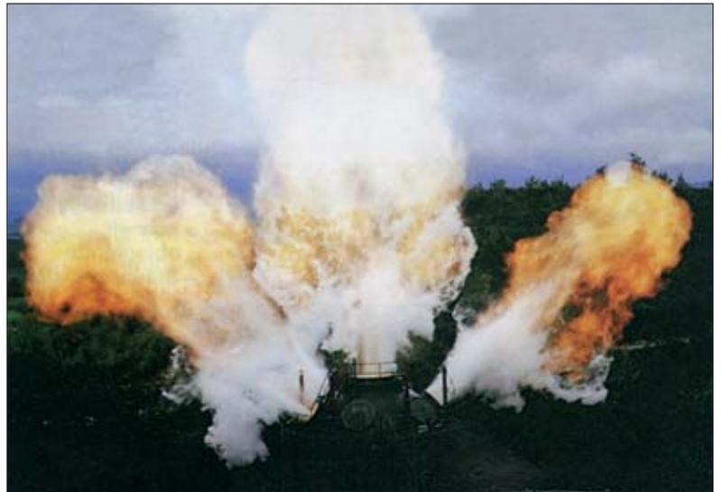
Bild 8: Sekundärexplosion ausserhalb des Behälters [5].
