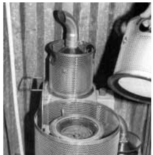
Bild 2: Abbrennstation zur Regeneration von Wechsel-PFS.
