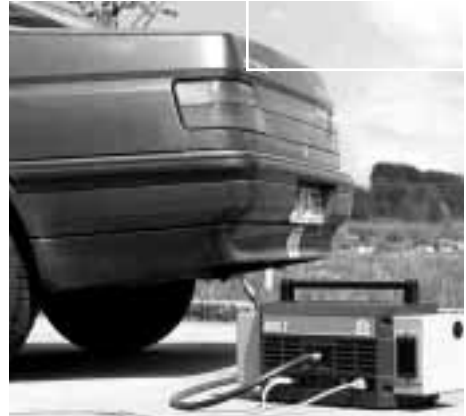
Bild 7: Mit dem Opazimeter (hier an einem Diesel-PW) wird regelmässig überprüft, ob die PFS die geforderte Abscheiderate erreichen.
