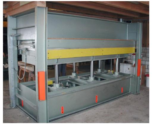
5 Stützen zum Unterstellen unter die bewegliche Platte
