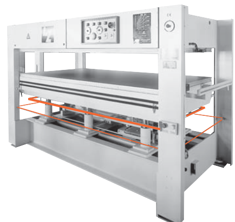
Bild 3: Die Schaltleiste oder Reissleine verhindert das Eingeklemmtwerden unter dem Tisch.
