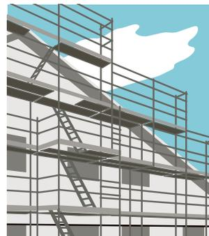
3 Accesso al tetto spiovente tramite un ponteggio dotato di torre-scala
