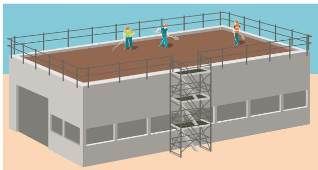
1 Accesso al tetto piano tramite una torre-scala all'esterno dell'edificio
