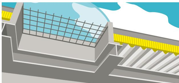
2 Apertura nel tetto (lucernario a cupola) con griglia di protezione fissa come protezione permanente
