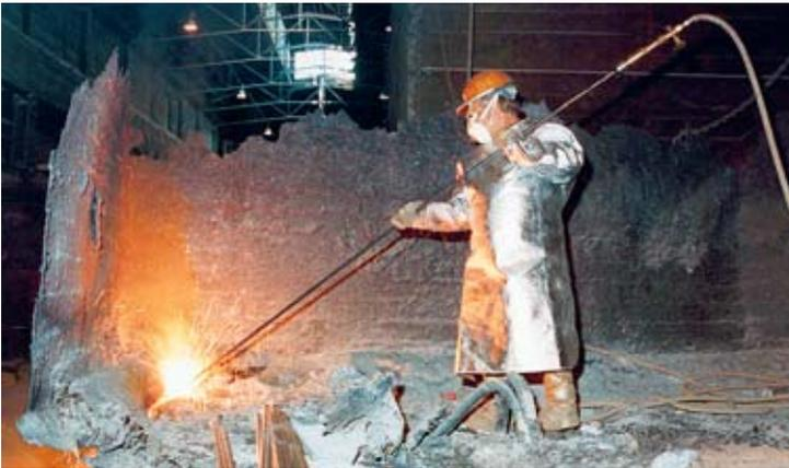
**Abb. 1** Brennschneiden mit Sauerstofflanze
