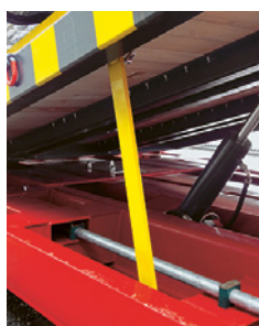
1 Piattaforma elevabile messa in sicurezza
