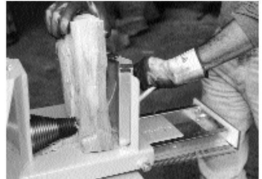
Bild 1: Die Holzzuführvorrichtung und die Verdeckung schützen vor dem Berühren der rotierenden Schraube.
