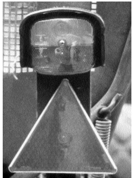
Bild 6: Balken mit reflektierendem Dreieckrückstrahler, Rückstrahler und Schlusslicht/Blinkanlage.
