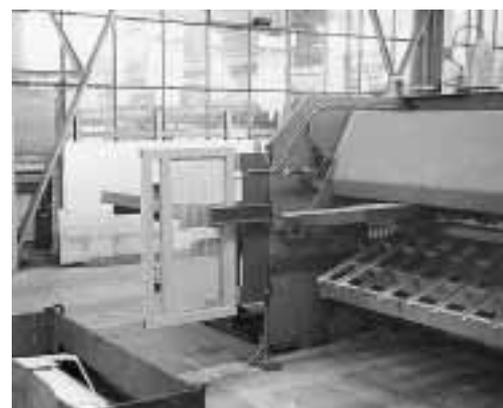
Figura 6: per rendere sicuro il macchinario si possono utilizzare barriere fotoelettriche, griglie di protezione, scivoli con riscontri fissi o trasportatori a rulli.
