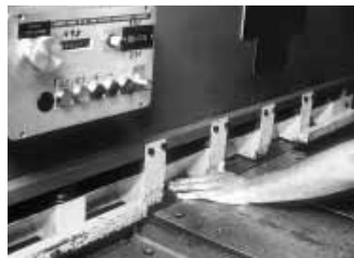
Figura 5: dispositivo di protezione con presa e buona visuale sul filo di taglio che consenta anche di tagliare lamiere di piccole dimensioni.
