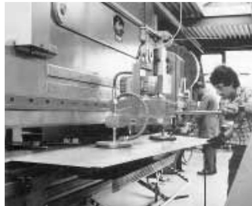
Figura 1: sistema pneumatico di sostegno montato sulla macchina per la lavorazione delle lamiere.
