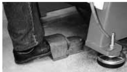
Figura 2: il comando a pedale deve essere dotato di una calotta di protezione.
