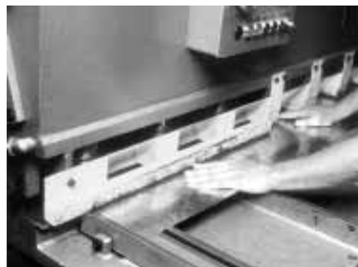
Figura 3: il dispositivo di protezione va disposto in modo tale che non sia possibile introdurre le mani sotto il premi-lamiera.
