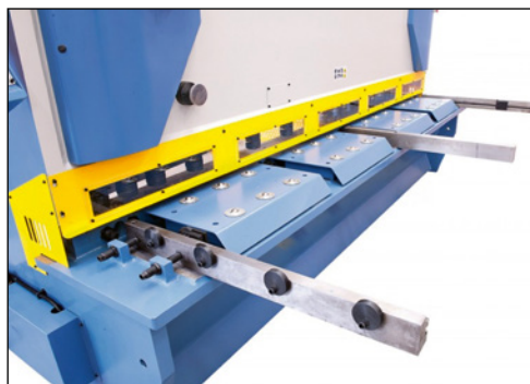
4 Per evitare ferite alle dita e alle mani il filo di taglio deve essere messo in sicurezza su tutta la sua lunghezza con un dispositivo di protezione fisso.
