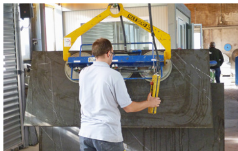
1 Sollevatore a ventosa per il trasporto delle lamiere
