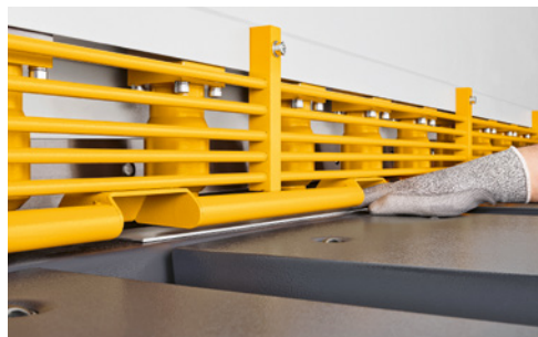
3 Dispositivo di protezione con presa e visuale chiara sul filo di taglio che consente di tagliare anche lamiere di piccole dimensioni.
