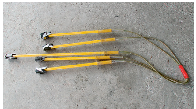
2 Garniture de mise à la terre sur ligne à basse tension
