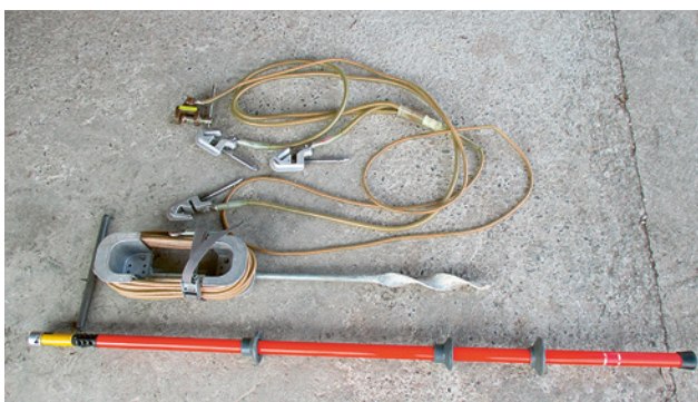
1 Garniture de mise à la terre sur ligne à haute tension (Les garnitures de mise à la terre doivent être conçues pour résister aux contraintes dynamiques et thermiques.)
