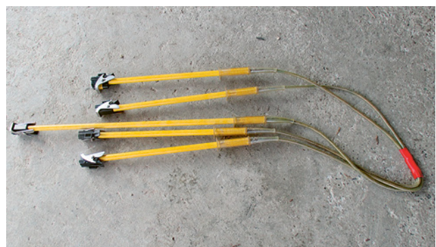
2 Garniture de mise à la terre sur ligne à basse tension
