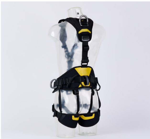
18 Harnais (SN EN 361) combiné avec ceinture de maintien (SN EN 358) et ceinture à cuissardes (SN EN 813) intégrées
