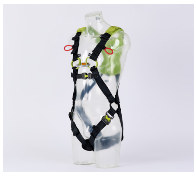
16 Harnais conforme à la SN EN 361 avec point d'attache antichute partagé au niveau de la poitrine (A/2) et anneaux d'arrêt pour les mousquetons (rouge)
