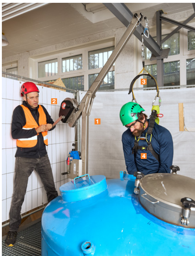
9 Système de sauvetage: 1 bossoire utilisé comme dispositif d'ancrage, 2 treuil, 3 longe, 4 harnais
