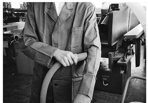
7 Per la pulizia non usare l'aria compressa, ma aspirare con l'aspirapolvere.
