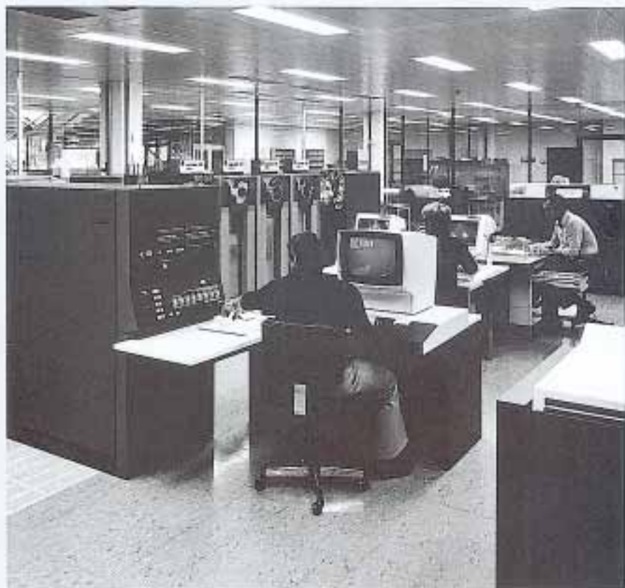
◀ 1978 – Zentrale Datenverarbeitungsanlage mit integrierter Bedienungskonsole und Bändeinheiten. Alle Komponenten der Anlage befanden sich in einem Raum.
