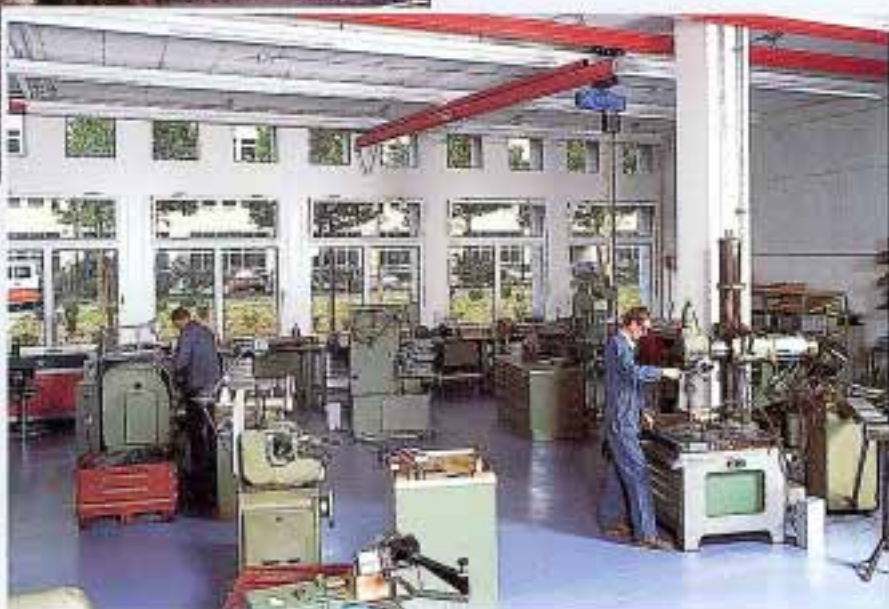
1992 – Helle und geräumige Werkstatt im SUVA-Gebäude Rösslimatt in Luzern. Im Gegensatz zu früher ist die Werkstatt heute auf zwei Räume aufgeteilt. Die Schweiss- und Schleifarbeiten werden in einem separaten Raum mit Staub- und Rauchabsaugung ausgeführt.
