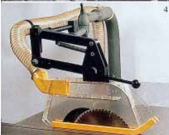
Bild 2 SUVA-Kreissägenschutzhaube 1920 mit Gegengewicht, das an einem Seil aufgehängt wurde.
