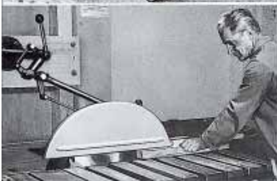
Bild 1 SUVA-Schutzhaube 1920 mit aufgeschraubtem Gegengewicht. Die Schutzhaube senkt sich selbsttätig in die Schutzstellung.
