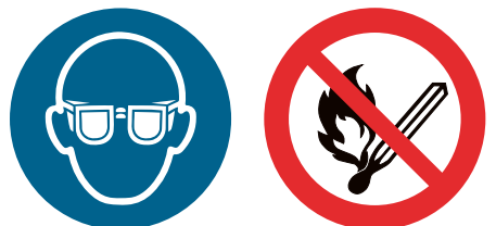
10 Erforderliche Sicherheitszeichen bei der Ladestation.
