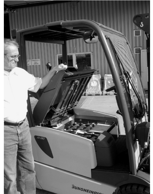
5 Anheben des Trogdeckels fürs Laden. So kann explosionsfähiges Gasgemisch entweichen.
