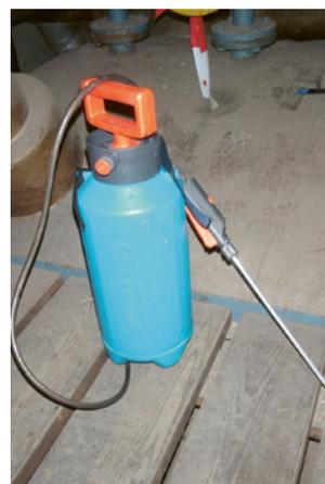
8 Spruzzatore con pompa a pressione
