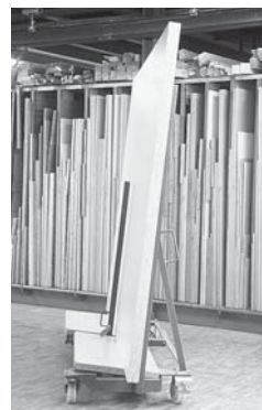
Bild 3: Kippsicherung: Wenn die Platten nicht gesichert sind, kann der Plattenwagen nicht verschoben werden.
