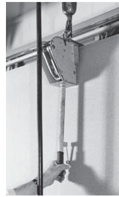
Bild 4: Das Eigengewicht des Greifers mit dem tief liegenden Schwerpunkt verhindert, dass der entlastete Greifer abfällt.
