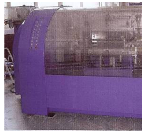
Encoffrage d'une machine
