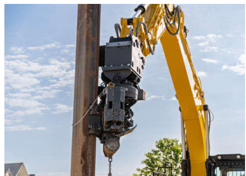
4 Vibroramme: Seitengriffrahmen können das Rammgut in einem Arbeitsgang aufnehmen, spannen und dann mit Vibration in den Boden rammen.
