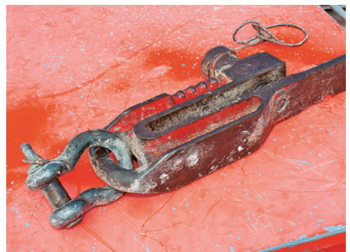
3 Sicherheitsschäkel gewährleisten ein sicheres An- und Abhängen von Bohrrohren, Spundwänden usw.
