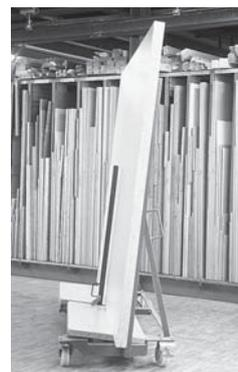
Fig. 3: protection contre le renversement. Le chariot ne peut pas être déplacé tant que les panneaux ne sont pas assurés.
