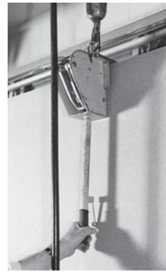
Fig. 4: le poids du grappin et son centre de gravité bas l'empêchent de tomber lorsque la traction de levage est interrompue.
